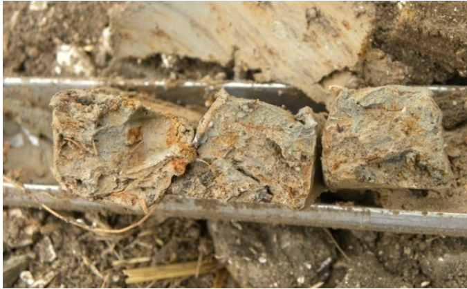
Taches de rouille et décoloration au sein d'un sol de zone humide Photo : C. Lucas - Ecothème
