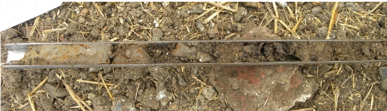
Profil de sol de zone humide avec des taches de rouille dès 20 cm de profondeur et 100 % de traits rédoxiques (taches rouilles et décoloration) dès 50 cm.
