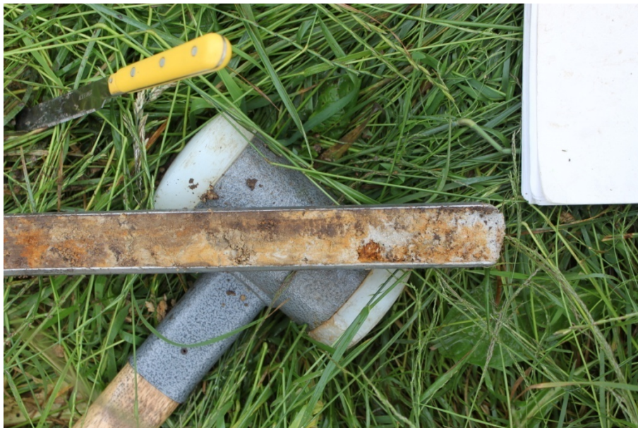
Exemple du matériel utilisé pour nos relevés pédologiques, le profil n'est pas détruit grâce à la tarière gouge. Photo : N. Conduche – Ecothème
